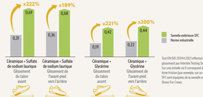
Test EN ISO 20344:2021 effectué pour déterminer la résistance au glissement par Intertek Testing Services Shenzhen Ltd, en août 2022. Sur une échelle où 0 correspond à l'absence de friction et 1 à une très forte friction (par exemple, sur un tapis sec). Toutes les chaussures SFC sont équipées de la semelle extérieure antidérapante brevetée Shoes For Crews.
